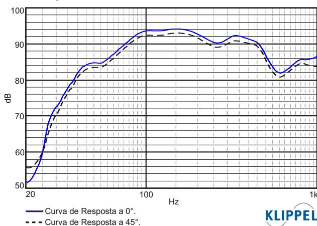
Curvas de resposta medidas com o subwoofer instalado na caixa de teste em câmara anecóica 1 W / 1 m.
